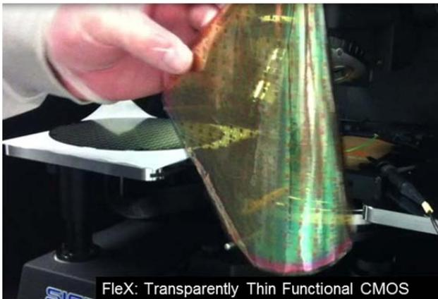
Figure 2: FleX Wafer – 130nm CMOS
