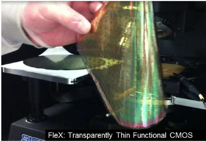
Fig. 3: 130nm CMOS Flex Silicon-on-Polymer Wafer
